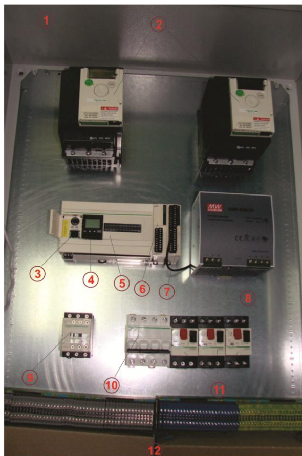
Fig. 12 Sistemul de monitorizare si control din componenta standului de probare
