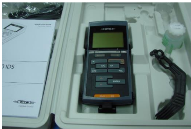
Fig. 13 Echipament multiparametru cu senzori digitali inteligenti- Multi 3510 IDS
