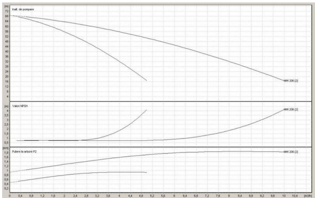
Fig. 8 Caracteristica de sarcină a grupului de pompare WILO ECONOMY CO-2 MHI 206/ER-RBI-CALOR
